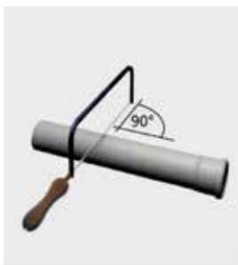
Bauteile winkelig schneiden und insbesondere entgraten
