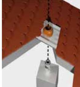
Schrägdachpfanne bzw. Flachdachkragen an vorgesehener Stelle in die Dachhaut einsetzen. Mündungsrohr durch die Pfanne mit Gleitschuh, bzw. den Flachdachkragen führen und ausrichten. Verbindungsleitung vom Wärmeerzeuger zum Mündungsrohr anbringen.
