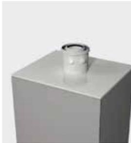
Anschlussstück am Kesselstutzen montieren. Messstück möglichst nahe am Wärmeerzeuger anbringen. Nötigenfalls Adapter zwischen Wärmeerzeuger und Messstück montieren. Revisionsöffnung in Abstimmung mit dem zuständigen Bezirksrauchfangkehrer bestimmen.
