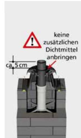
Halteseil in Ösenloch der Wetterhaube einfädeln. Wetterhaube über Mündungsrohr schieben und auf Unterteil fest einrasten.
