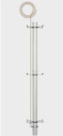
Rohre und Formstücke nach zuvor bestimmter Länge mittels mitgeliefertem Gleitmittel zusammenstecken.
