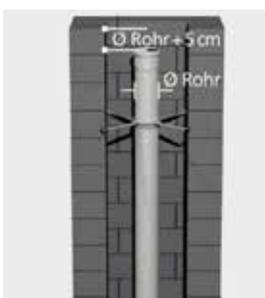
Das letzte Rohr soll aufgrund einer möglichen Metall-Mündungsausführung an bestimmter Stelle unter Schachtoberkante enden. Folgende Formel: Außenrohrdurchmesser Abgasleitung + 5 cm. Darüber hinaus kann ein Mündungsrohr auch später besser getauscht werden.
