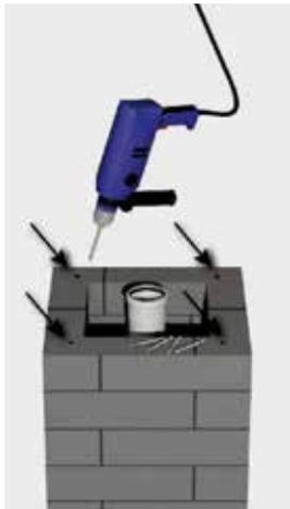
Schachtmündung vorbereiten für Montage der Kaminschachtabdeckung. Vier Befestigungspunkte festlegen und Bohrungen für mitgelieferte Schlagdübel M6 vornehmen.
