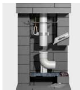
Senkrechte Abgasleitung mit Bogen 87° mit Stützfuß verbinden. Eventuelle Verunreinigungen an der Muffe des Bogens entfernen. Mitgeliefertes Gleitmittel verwenden
