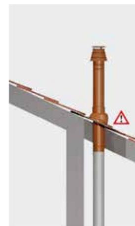
Je nach Dachüberstand ist mit einer Dachdurchführung mit Schrägdachpfanne oder Flachdachkragen zu arbeiten.
