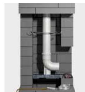
Die mögliche Montagehilfe (Seil, Rohrschelle...) von der Abgasleitung lösen und aus Schacht entfernen.
