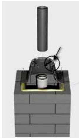
Unterteil der Kaminschachtabdeckung montieren mittels mitgelieferter Schlagdübel. Geeignete Dichtmasse (witterungs- und UV-beständig) zwischen Schacht und Kaminschachtabdeckung verwenden. Mündungsrohr durch die Kaminschachtabdeckung einschieben und in die letzte Rohrmuffe einstecken. Halteseil in Ösenloch montieren.
