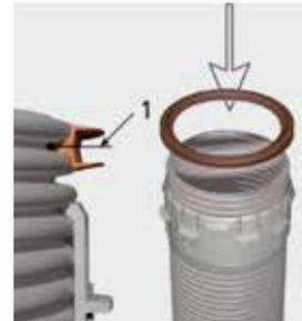
Montagering mit Nasen in Rille Nr. 3 positionieren. Dichtung (2 Lippen außen) in Rille Nr. 1 positionieren.
